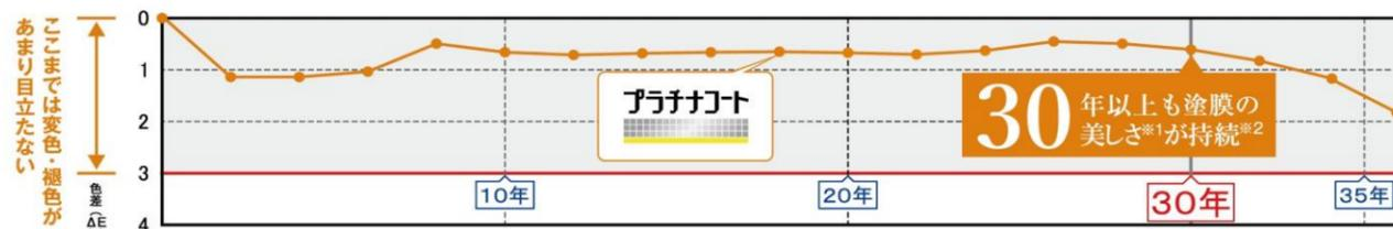
■社内試験結果(当社独自基準)〔促進耐候性試験(SWOM試験)〕強い陽射しや熱、雨などの過酷な自然環境を再現する試験です。
