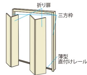
■三方枠仕様(薄型直付けレール)
